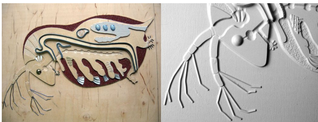
Abbildung 4.2: Vorlage für einen Tiefziehdruck und Ergebnis (Wasserfloh) 46
