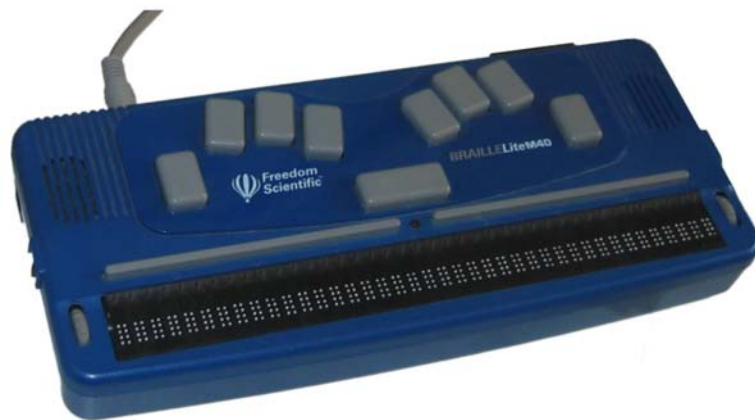
Abbildung 2.3: Braille-Notizgerät mit 40 Zeichen
