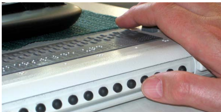
Abbildung 2.5: Lesetasten an der Front einer 80-Zeichen-Braillezeile
